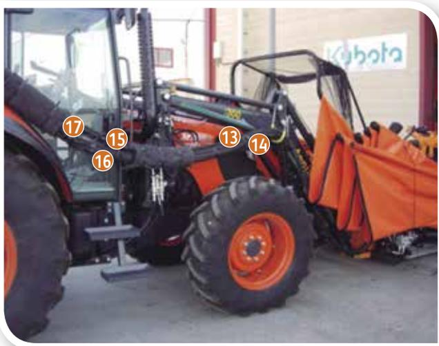
**CILINDRO SERRAGGIO PINZA Ø95 (x2) Rif. V113100**
