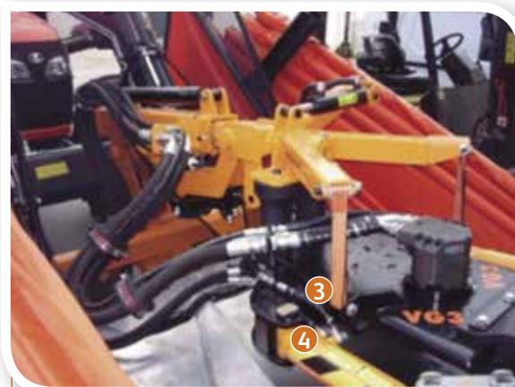
**CILINDRO SERRAGGIO PINZA Ø95 (x2) Rif. V113100**
