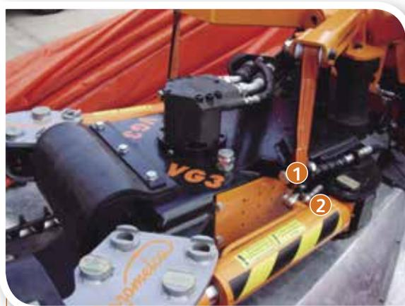
**CILINDRO SERRAGGIO PINZA Ø95 (x2) Rif. V113100**
