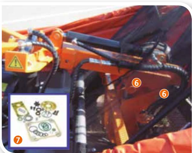
VÉRIN ÉLÉVATION MACHINE Réf. V121300
