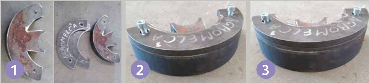
La puissance peut être augmentée ou diminuée en ajoutant des suppléments sur le contrepoids en fonction de l'espèce d'arbre pour lequel il faut procéder à la récolte.
