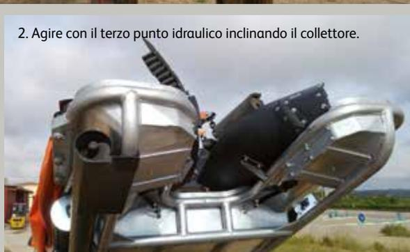
3. Se la rotazione con il terzo punto idraulico non è sufficiente, dovremo azionare il pulsante nero (elevazione della macchina), muoverlo in indietro e mantenerlo in questa posizione. In questo modo, l'ombrello realizzerà un giro simile a quello di una pala. Connettersi coclee di scarico.
