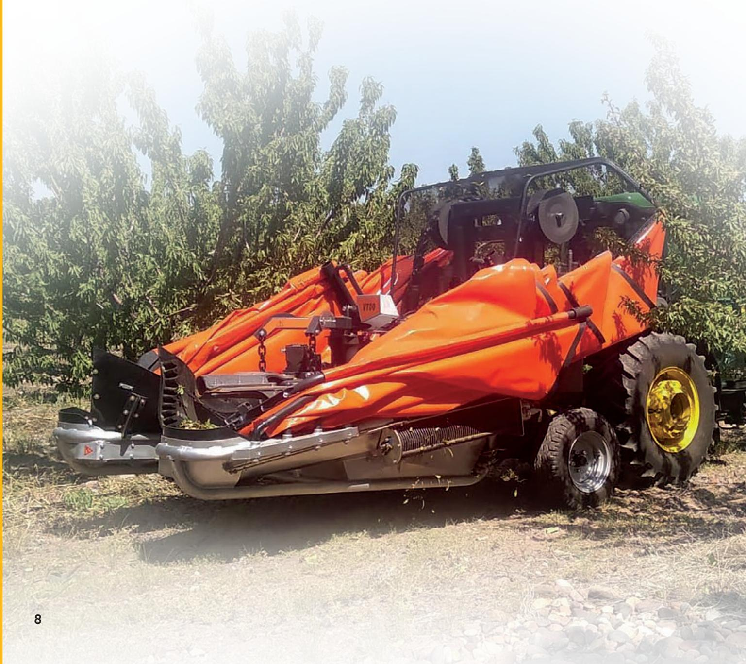
Com esta plataforma, conseguimos reduzir o peso de um guarda-chuvas convencional (ferro), pelo que reduzimos enormemente o desgaste e as avarias do veículo que suporta o peso, aumentamos a manobrabilidade do veículo, a estabilidade, a segurança, a agilidade de manobras e a rapidez nos deslocamentos.
