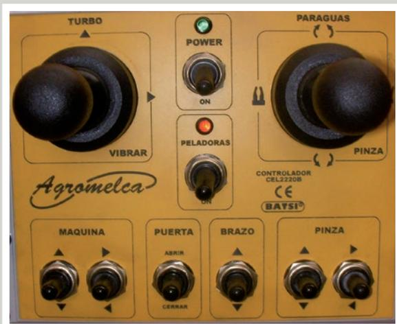
Os movimentos e a vibração realizam-se de forma muito cómoda e simples, por intermédio de uma caixa eletrónica equipada com joysticks e seletores.
